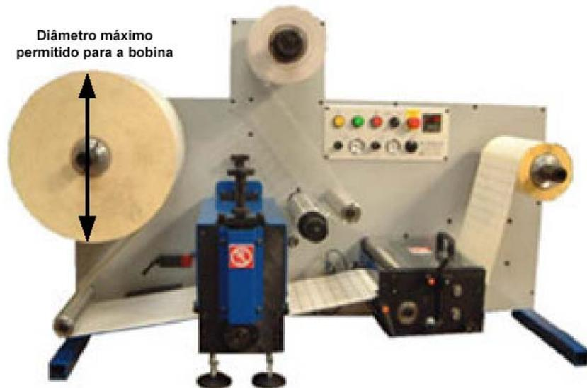
**FIGURA 3 – Exemplo de uma máquina rotativa e o limite máximo permitido para o diâmetro da bobina. Fonte: <http://www.daco-solutions.com>**
