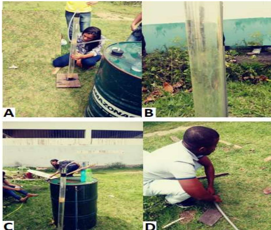
Figura 2. Observação do nível na água o tubo; (B) tubo seco; (C) reservatório de água; (D) condução da água até o buraco no solo.
