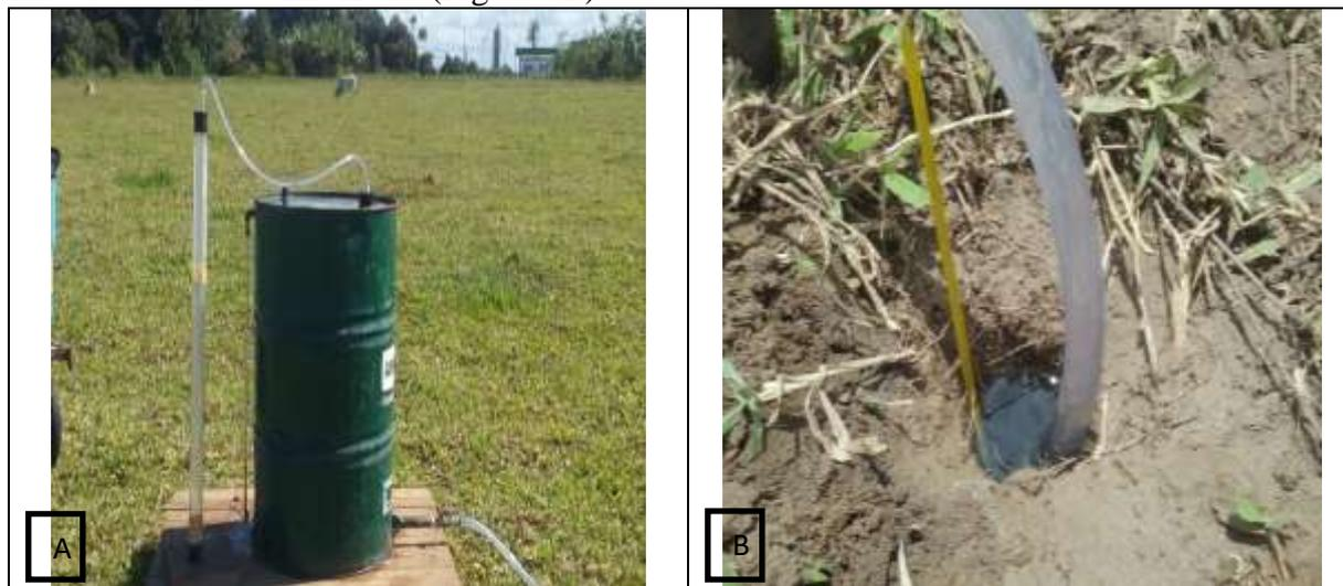
Figura 3 A) Vista do túnel reabastecedor de 200 L, juntamente com o frasco de Mariott de acrílico e B) Furo no solo com a mangueira reabastecedora e termômetro.
