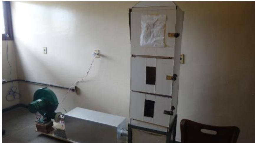
**Figura 1** – Secador de sementes e frutas em escala de laboratório.
